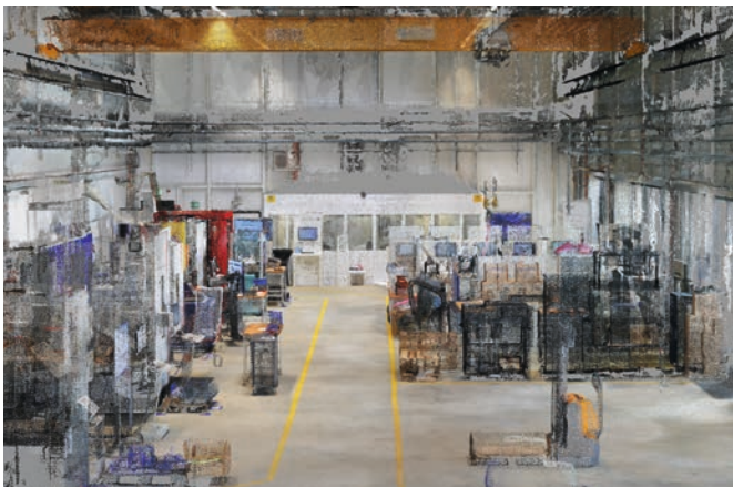
Mithilfe von KI werden sämtliche Objekte der Fabrikanlage automatisch erkannt und in CAD-kompatible Modelle umgerechnet
