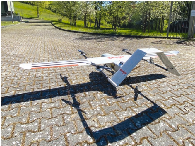
Die Drohne Beagle M kurz vor dem Einsatz an einer Stromtrasse
