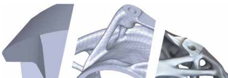
Schrittweiser Übergang von einem massiven Grundkörper zu einer optimalen Leichtbaustruktur eines Radträgers.
