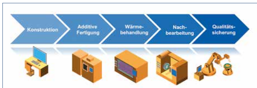
Prozesskette der Additiven Fertigung.
