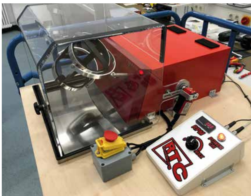
Der Turbula-Mischer im Testeinsatz am Lehrstuhl Hybrid Additive Manufacturing.
