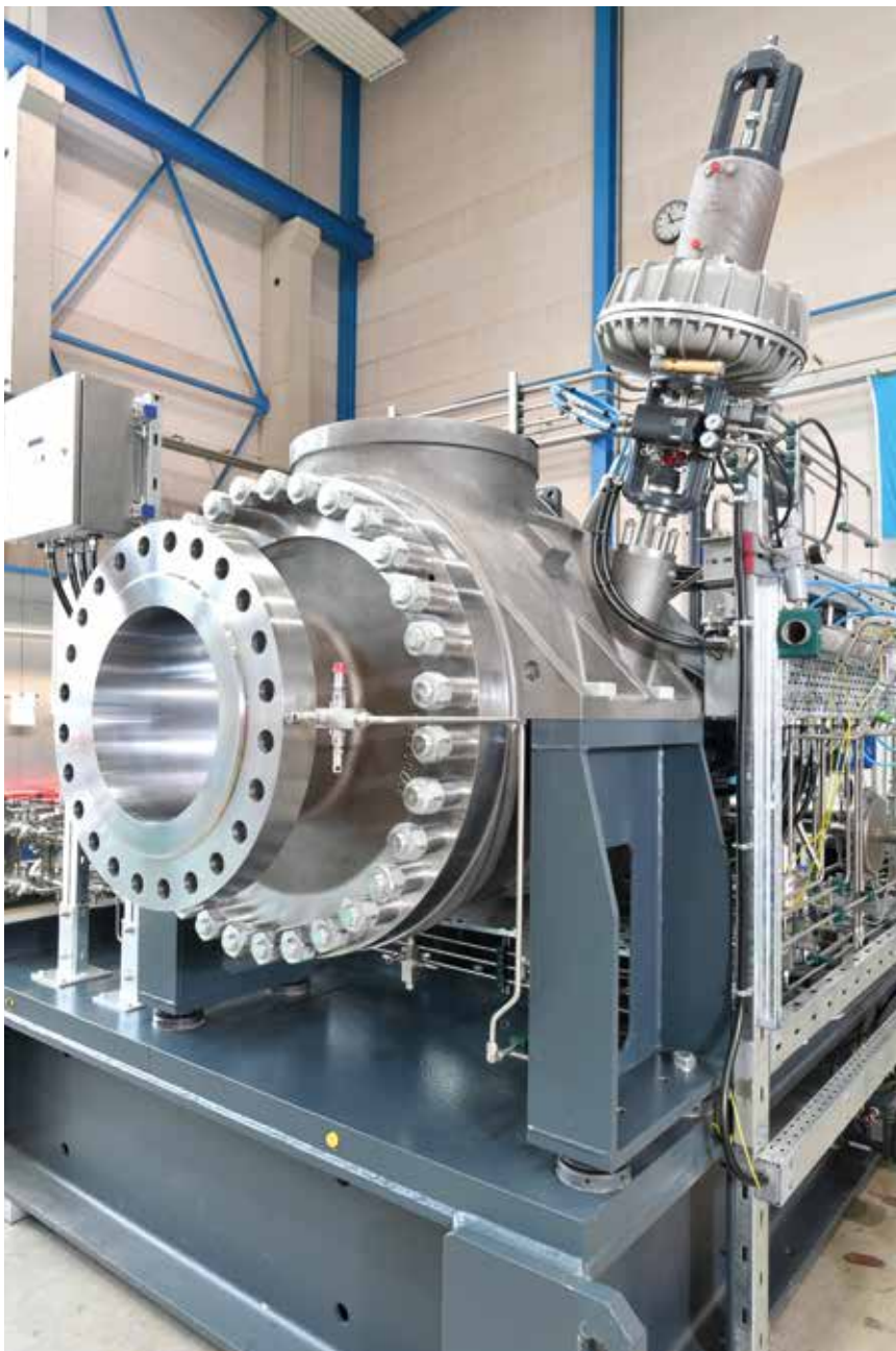
Expansionsturbine für eine Erdgasanwendung.
