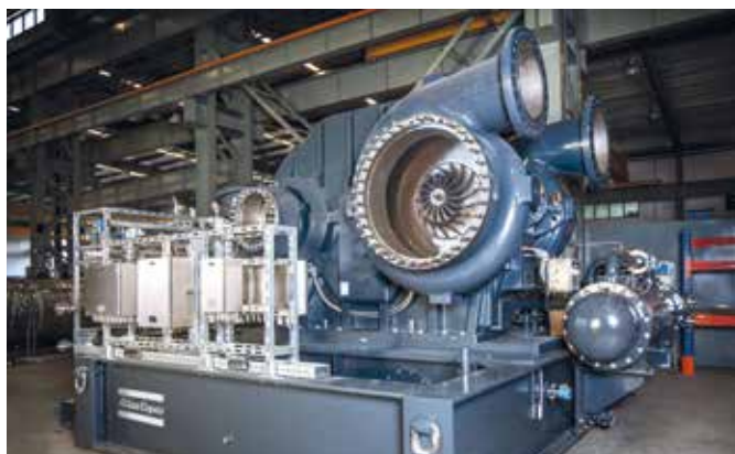
Getriebeturboverdichter von Atlas Copco Energas.
